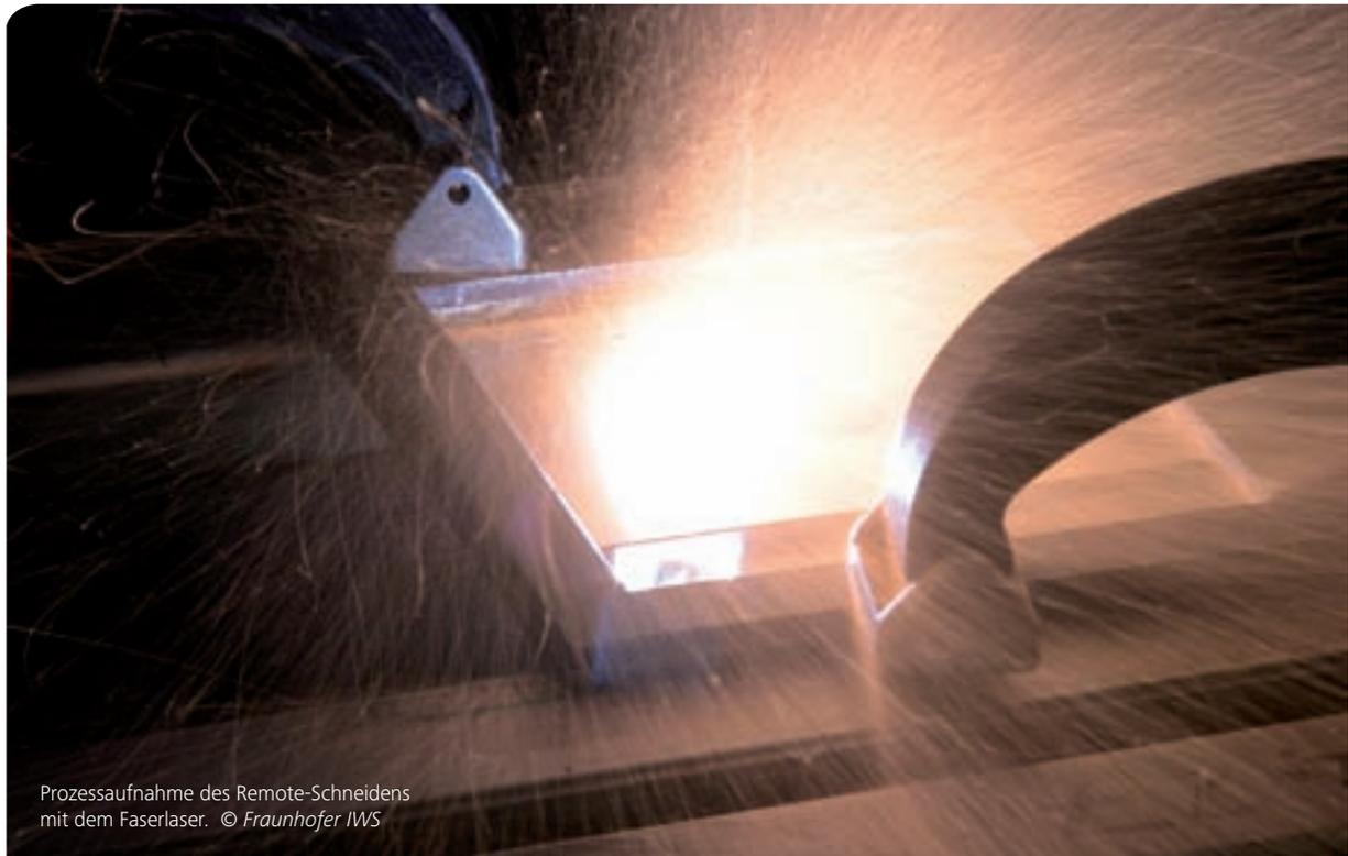
Prozessaufnahme des Remote-Schneidens mit dem Faserlaser. © Fraunhofer IWS
