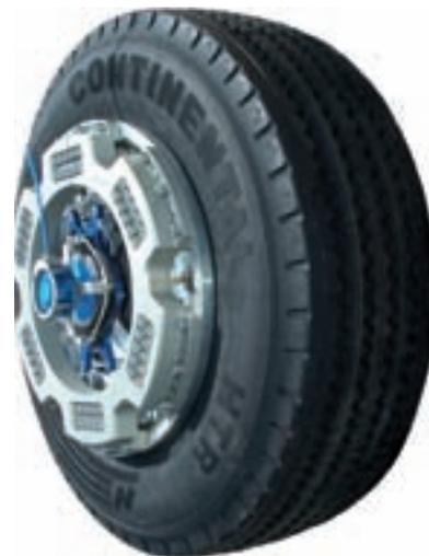
In die Messräder sind bis zu sechs Sensoren integriert, die alle auf das Fahrzeug wirkenden Einflüsse aufzeichnen.
