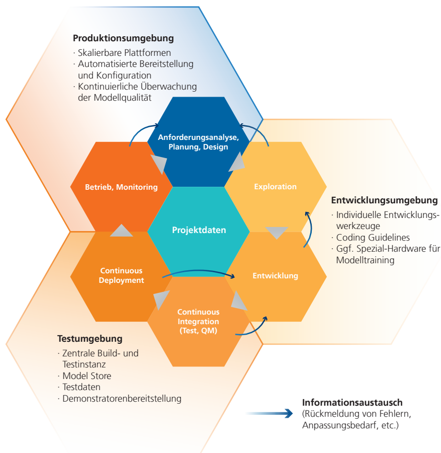
Abbildung 4: ML-Engineering-Prozess mit Kommunikationsflüssen und zentralen Funktionalitäten
